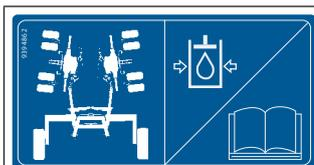
Cet autocollant indique que la machine est commandée par pression hydraulique et qu'il faut lire la notice d'utilisation.
