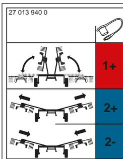
Cet autocollant indique les raccordements hydrauliques possibles de la machine. Pour davantage d'informations sur l'accouplement des flexibles hydrauliques : [voir Page 56](#).
