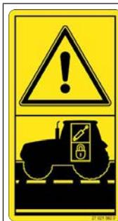
**Опасность из-за незаблокированных управляющих клапанов трактора**
