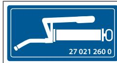
На машине имеются несколько точек смазки, которые необходимо регулярно смазывать, *см. Страница 127*. Скрытые места смазки дополнительно обозначены этой указательной наклейкой.
