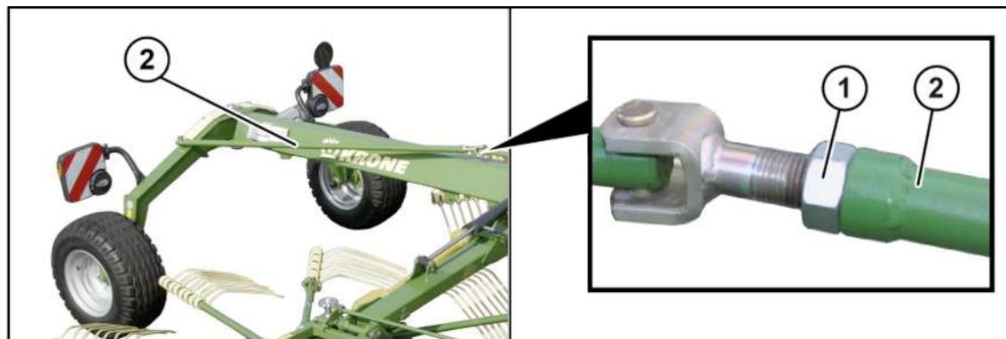
Если валкователь на ровной дороге не движется по центру за трактором, это можно отрегулировать путем перестановки тяги управления (2).
