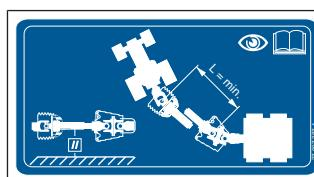
Наклейка расположена рядом с карданным валом и указывает, что при регулировке карданного вала должна быть соблюдена инструкция по эксплуатации, см. [Страница 44](#).
