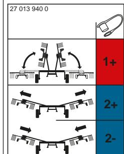
Наклейка отмечает возможные гидравлические подключения машины. Дополнительная информация о подсоединении гидравлических шлангов: [см. Страница 53.](#)
