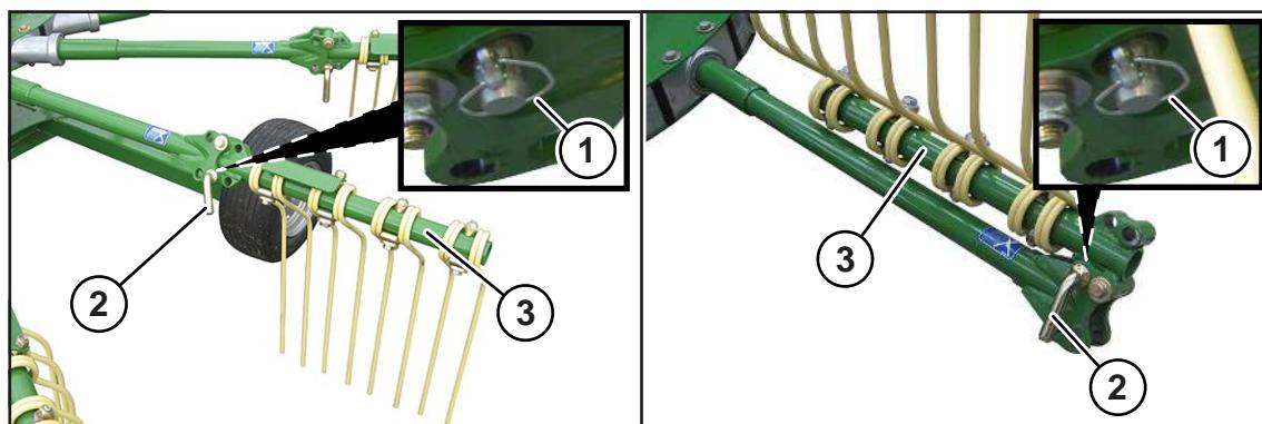
Складные граблины должны быть повернуты в транспортное положение в определенной последовательности.
