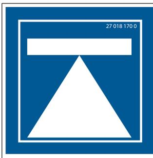
La machine comprend des points d'appui du cric identifiés par cet autocollant, [voir Page 251](#).
