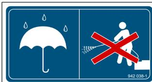
Les zones repérées par cet autocollant doivent être protégées des projections d'eau. Le jet d'eau d'un nettoyeur à haute pression ne doit en particulier pas être dirigé sur les paliers et le système électrique/les composants électroniques.
