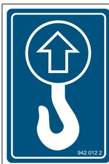
La machine comprend des points de levage identifiés par cet autocollant, [voir Page 180](#).
