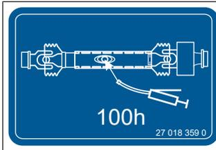
L'autocollant se trouve sur les arbres à cardan. Il indique qu'il faut lubrifier les arbres à cardan toutes les 100 heures de fonctionnement.
