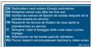
Cet autocollant indique que les écrous de roue doivent être resserrés après la première utilisation.
