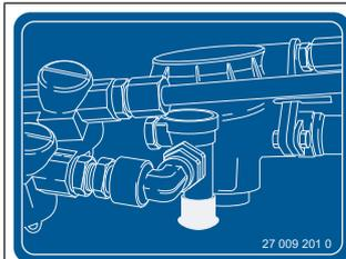
L'autocollant se trouve dans la zone de la vanne de desserrage du frein à air comprimé et indique où se situe le bouton-poussoir à actionner pour déclencher la vanne. [voir Page 73](#)
