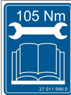
Cet autocollant indique que les raccords à vis doivent être serrés à un couple de serrage de 105 Nm.
