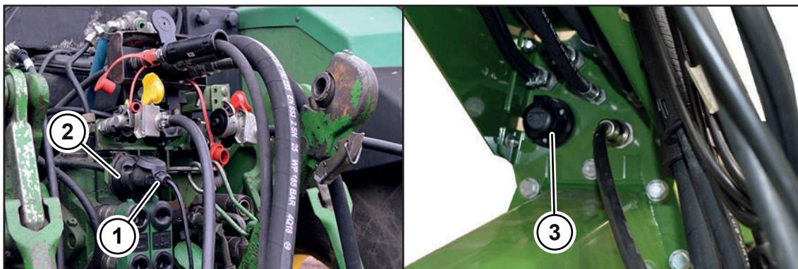
Осветительное оборудование подключается посредством имеющегося в комплекте 7-полюсного соединительного кабеля (1).
