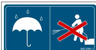
Участки, отмеченные этой наклейкой, должны быть защищены от брызг воды. В особенности запрещается направлять струю воды установки для чистки под высоким давлением на подшипники и компоненты электрики/электроники.
