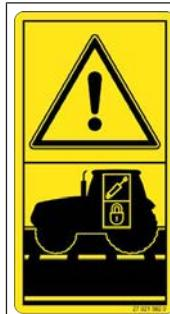
**Nebezpečí při nezajištěných řídicích ventilech traktoru**
