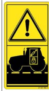
**Nebezpečí při nezajištěných řídicích ventilech traktoru**
