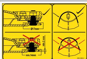
Наклейка указывает на то, что стопорные пальцы в модификации с быстродействующим ножевым замком при каждой смене ножей или контакте с посторонним предметом проверяются и, если потребуется, должны быть заменены авторизованными специалистами.
