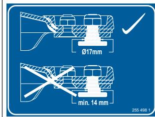
Наклейка указывает на то, что стопорные пальцы в модификации с резьбовым ножевым замком при каждой смене ножей или контакте с посторонним предметом проверяются и, если потребуется, должны быть заменены авторизованными специалистами.
