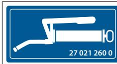
На машине имеются несколько точек смазки, которые необходимо регулярно смазывать, см. [Страница 96](#). Скрытые места смазки дополнительно обозначены этой указательной наклейкой.
