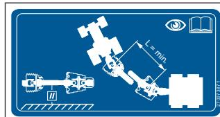
Samolepka se nachází v blízkosti kloboukového hřídele a uvádí, že je třeba dodržovat při přizpůsobení hřídele provozní návod, *viz Strana 46*.
