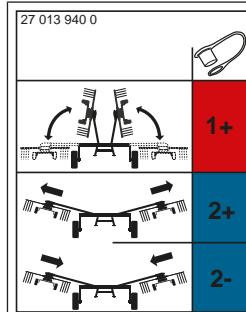
Samolepka ukazuje možné hydraulické spoje stroje. Pro další informace k připojení hydraulických hadic: *viz Strana 53*.
