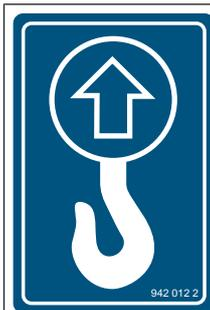
La machine comprend des points de levage identifiés par cet autocollant, [voir Page 89](#).
