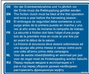
Cet autocollant indique que l'accouplement à friction doit être purgé avant la première mise en service et une fois par an, avant la saison.
