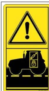
**Danger dû à des soupapes de commande non verrouillées du tracteur**
