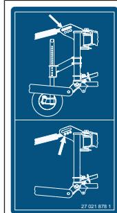
Nálepka se nachází na stroji s opěrným kolem a uvádí, jak se má horní táhlo namontovat na tříbodový závěs, viz [Strana 47](#).
