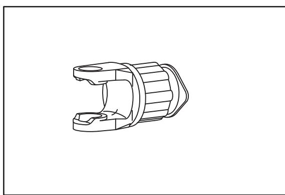
Pojistka proti přetížení chrání traktor a stroj před zátěžovými špičkami. Může ale zareagovat i při nízkých otáčkách nebo při rozběhu rotorů. Pokud k tomu dojde, kloubový hřídel se otáčí, ale rotory stojí nebo se otáčejí s nižšími otáčkami. Krátkodobá reakce pojistky proti přetížení neovlivní funkci stroje.
