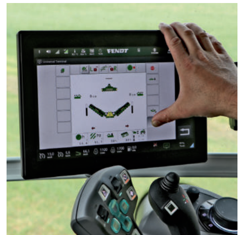
Die Komfortbedienung erfolgt über Joystick und ISOBUS-Terminal, hier vom Traktor.
