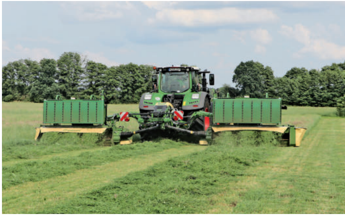
Schwenken die Bänder nach oben, legt das Mähwerk das Futter auf drei Schwade breit ab.
