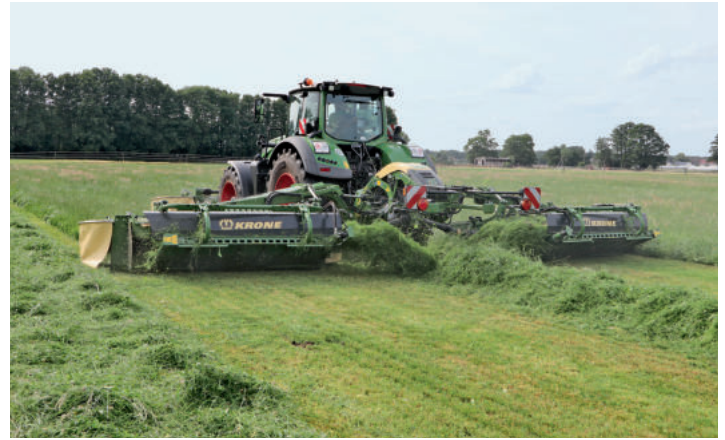
Durch die variable Bandgeschwindigkeit lassen sich kompakte Schwade formen.
