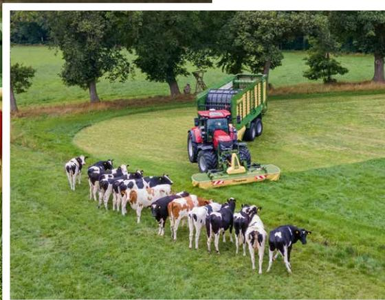
Ottimizzando il condizionamento del materiale di raccolta, il gruppo di trattamento CV garantisce ridotti tempi di giacenza sul campo e un'elevata qualità del foraggio.
