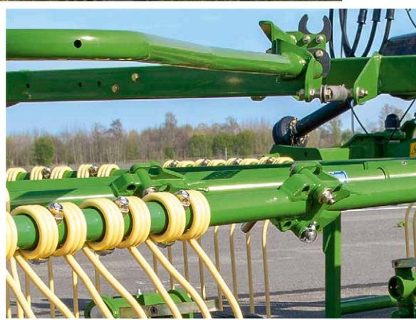
Grâce aux rondelles-ressort intégrées, les moitiés de bras porte-dents sont verrouillées entre-elles en position dépliée. Cela signifie l'absence d'usure de l'axe de verrouillage ou du trou d'insertion. Cela garantit un raccord sans jeu, une énorme durabilité et une fiabilité d'utilisation pendant de nombreuses années de récolte.
