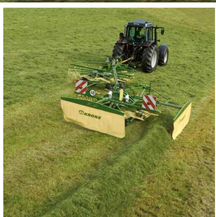
Depósito de una hilera Una hilera de 6,20 m
