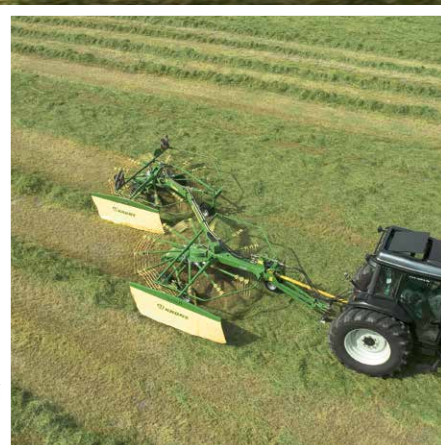
Depósito de dos hileras Dos hileras de 6,80 m
