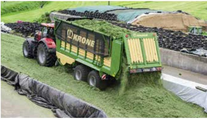
2800 Nm sichern die drei Dosierwalzen ab. Das ermöglicht höchste Entladeleistungen bei trotzdem gleichmäßigem Austrag.
