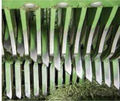
Die Rotorzinken sind 22 mm breit. Die Form wurde für einen besseren Scherenschnitt entlang der Messer angepasst.
