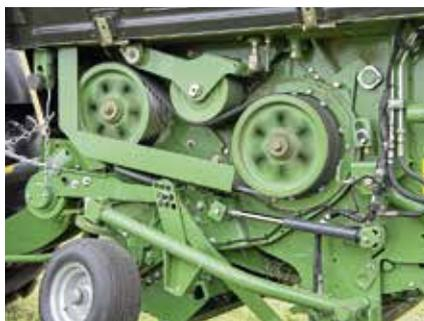
Von der BiG Pack übernommen: der Antrieb mit Verbundriemen und neuem Planetengetriebe im Rotorgehäuse.
