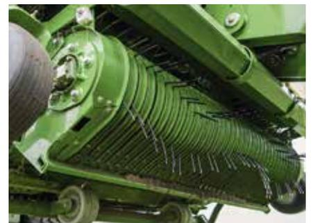
Eine automatische Drehzahlregelung der ungesteuerten Pickup gibt es auf Wunsch. Die Tastrollen hinter der Pickup dürften breiter sein.
