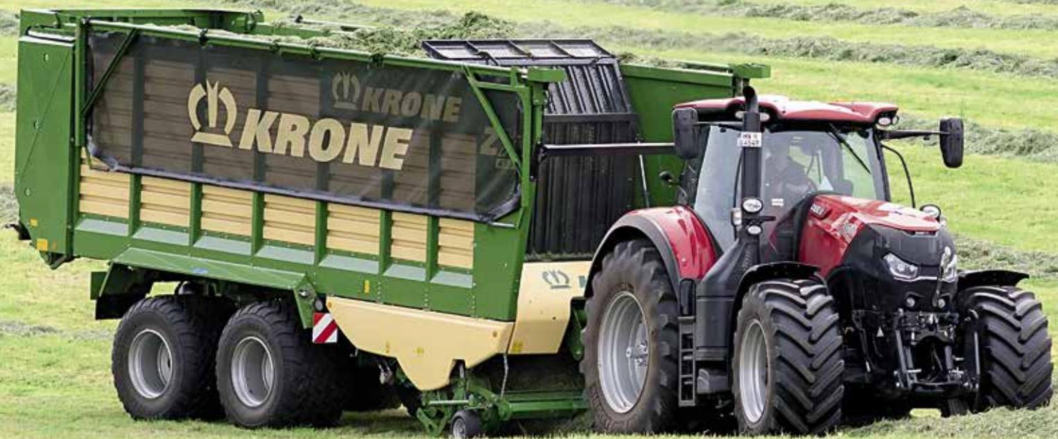
Mit Verbundriemenantrieb am Rotor und klappbarer Stirnwand ist der neue ZX-Kombiladewagen auf hohe Durchsatzleistungen getrimmt.
