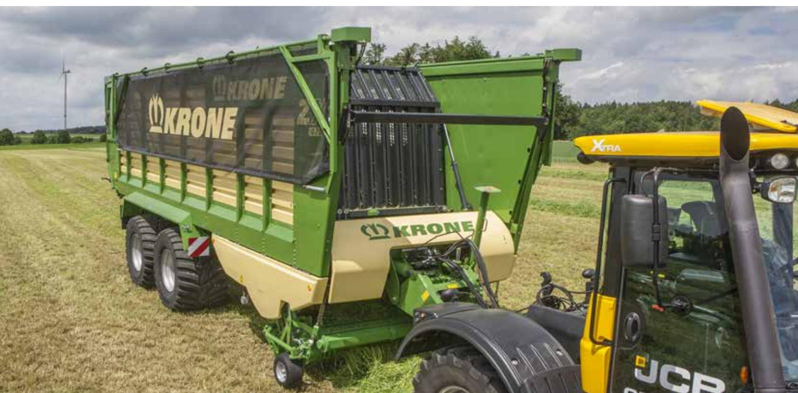
die Schwaden zu klein bzw. der Aufwuchs zu gering, sollte die Zapfwellendrehzahl reduziert werden. Das verbessert die Rotorfüllung und damit die Schnittqualität.
