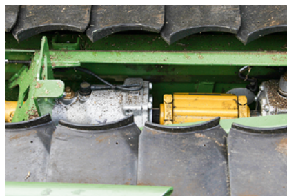
Neben der Einzelsicherung sind die Sichelscheiben paarweise per Sternratsche abgesichert.
