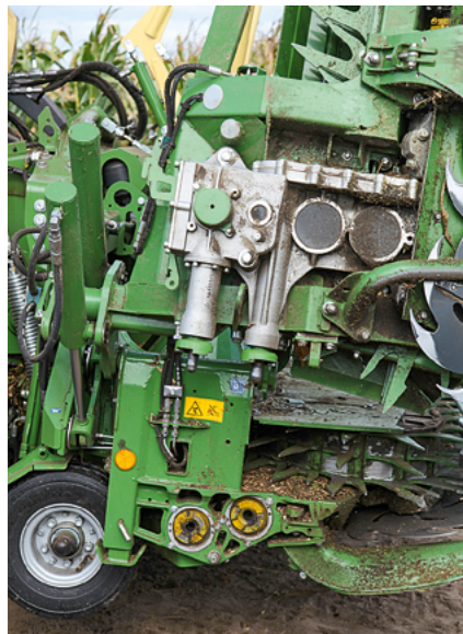
Zwei Antriebsstränge: einer für die Kollektoren, der andere für die Sichelscheiben.
